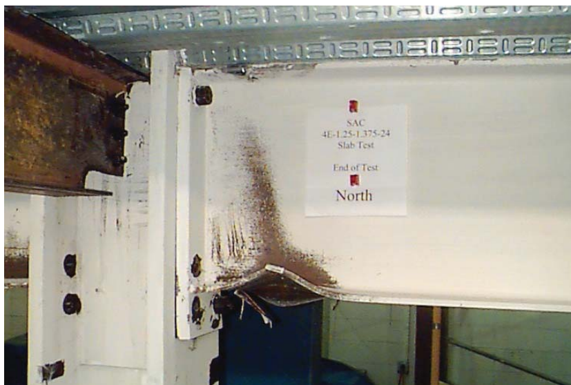
(ج) گیسختگی زودهنگام در اتصال ورق انتهایی
