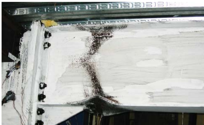
(ب) کمانش بال پایین و تسلیم در تیر
