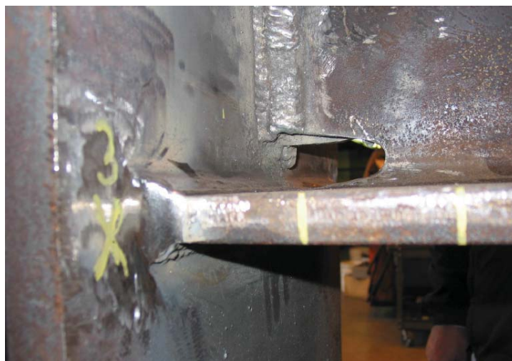
شکل ر-۱۲-۳ بال پایینی تیر پس از حذف ناودانی انتهایی جوش
