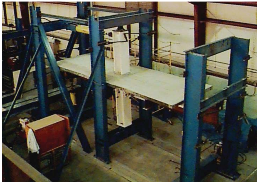
(ب) نمونه‌ی آزمایشگاهی اتصال ورق انتهایی
